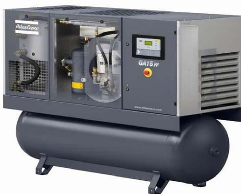
La macchina prevista in progetto quindi è un compressore d'aria volumetrico rotativo con elemento vite monostadio lubrificato ad olio e raffreddamento ad aria. Al suo interno racchiude uno stadio di compressione di ultima generazione, accoppiato direttamente con un motore elettrico ad alta efficienza Eff1 con protezione IP55, oltre ai sistemi di lubrificazione, raffreddamento e regolazione.
