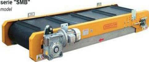
Sul flusso di sopravaglio, effluente dal 2° stadio di vagliatura, viene operata una demetallizzazione completa , attraverso l'impiego di un separatore magnetico a magneti permanenti, diversi da quelli a nastro impiegati in testa all'impianto, in conformazione bipolare con struttura in ferro a basso tenore di carbonio realizzato con magneti permanenti in Sr Ferrite ad elevata induzione magnetica e grande forza coercitiva (con garanzia efficienza campo magnetico 20 anni)
