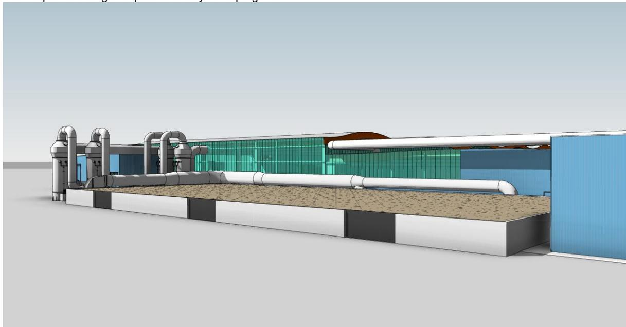
Figura 48 Dettaglio Scrubber e biofiltro in progetto
