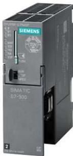
Il programma di gestione delle funzioni dell'impianto è realizzato utilizzando l'ambiente di sviluppo Simatic Step 7 in accordo con le normative internazionali IEC-1131.3 e comunitarie EN-60 1131.3.
