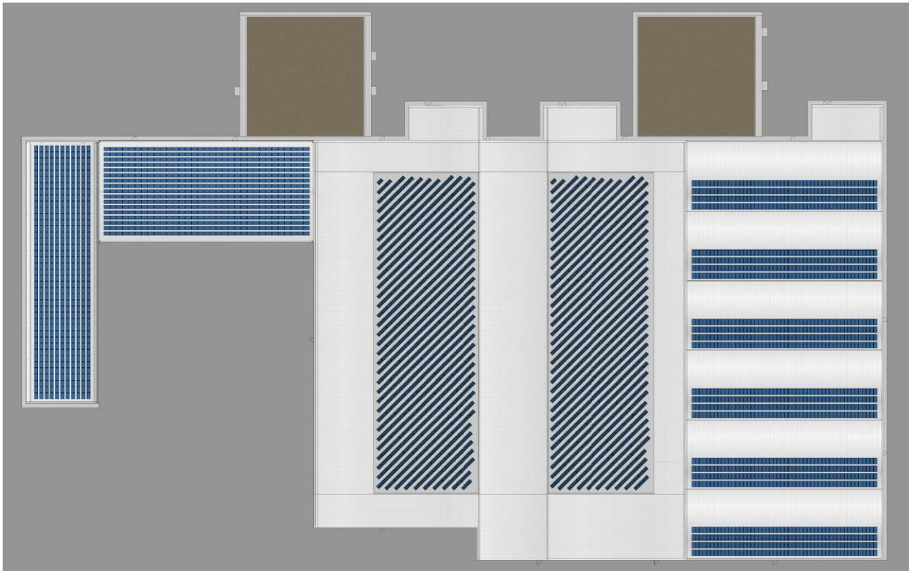
Figura 4 - Planimetria delle coperture con evidenza degli elementi fotovoltaici
