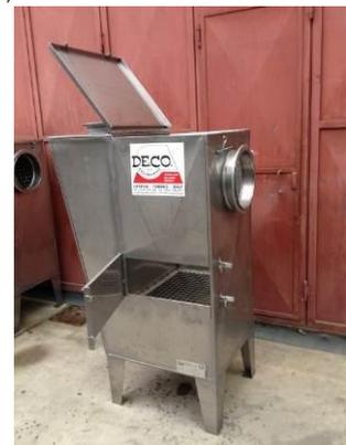
Il loro dimensionamento viene eseguito per garantire una velocità di circa 5m/s, una velocità calcolata per rallentare il flusso gassoso e facilitare il deposito delle impurità sulle ampie superfici di contatto create dai corpi di riempimento.
