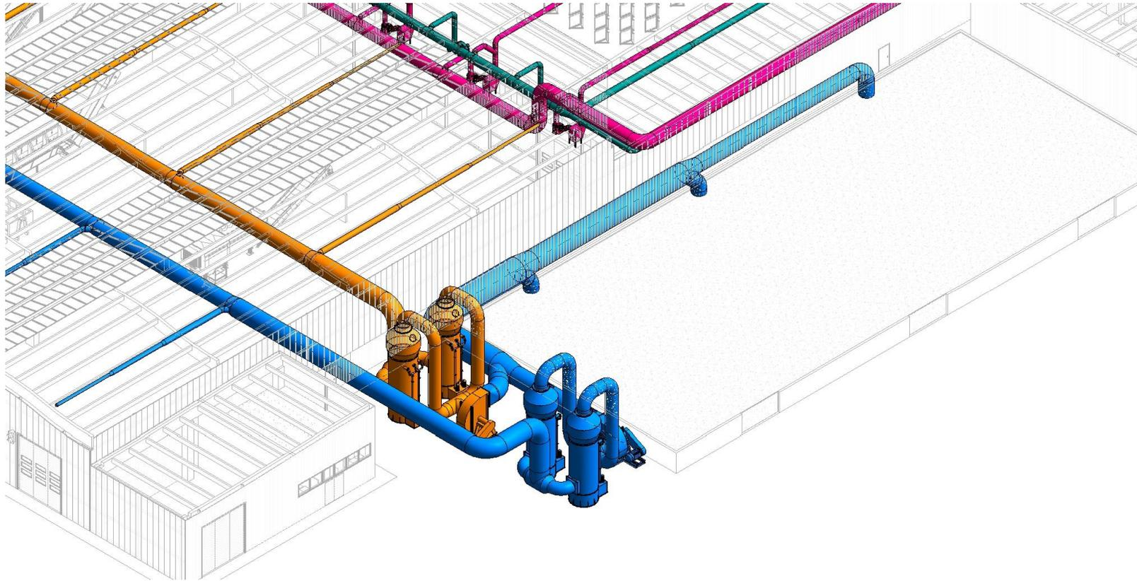
Figura 53 Vista 3D del sistema doppio scrubber e immissione aria nel biofiltro
