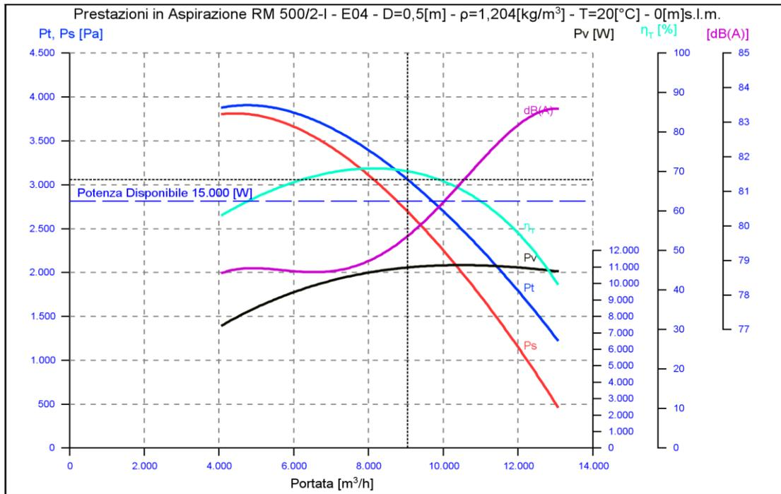
Figura 19 Curva caratteristica ventilatore estrazione aria da biocelle trattamento FOS
