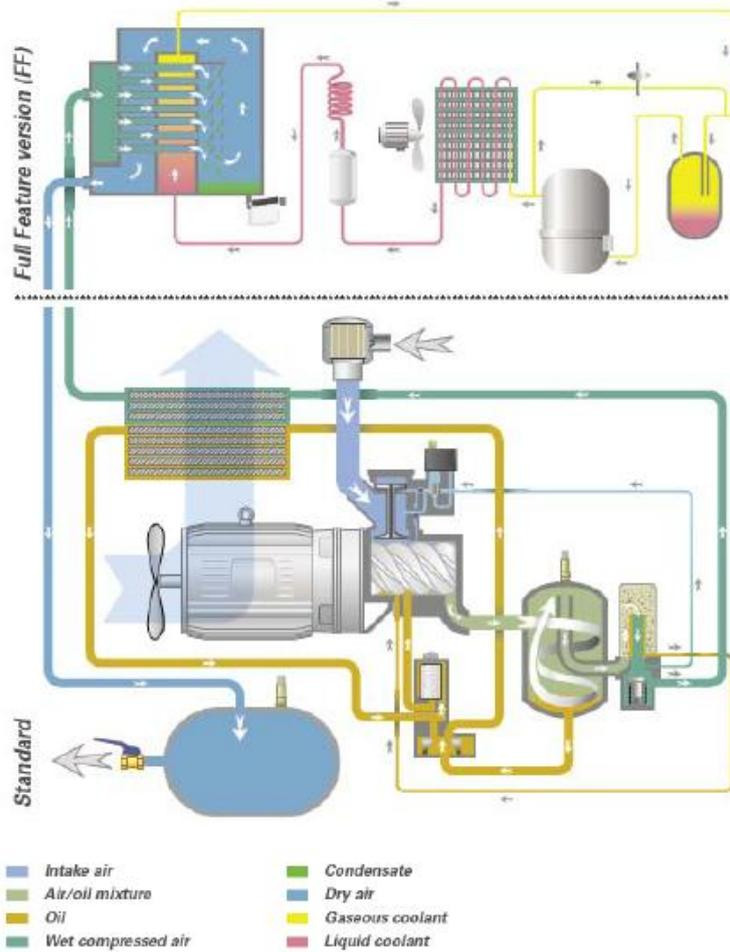
Figura 46 Diagramma di flusso del sistema aria compressa previsto in progetto
