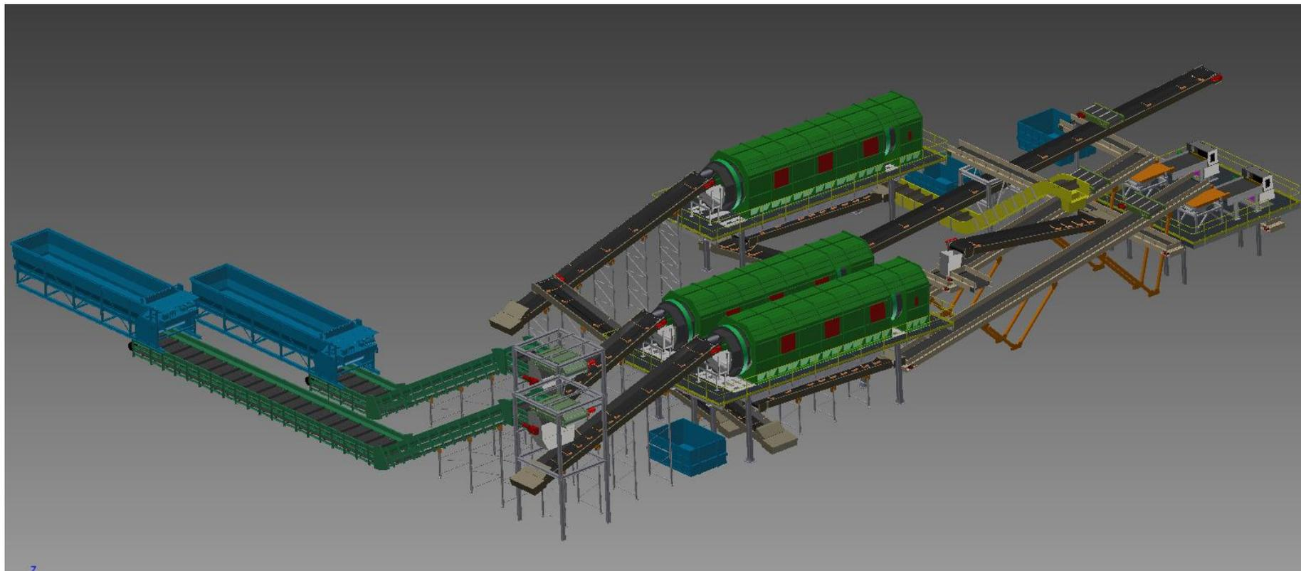
Figura 6 Vista 3D della linea di pretrattamento dei RSU
