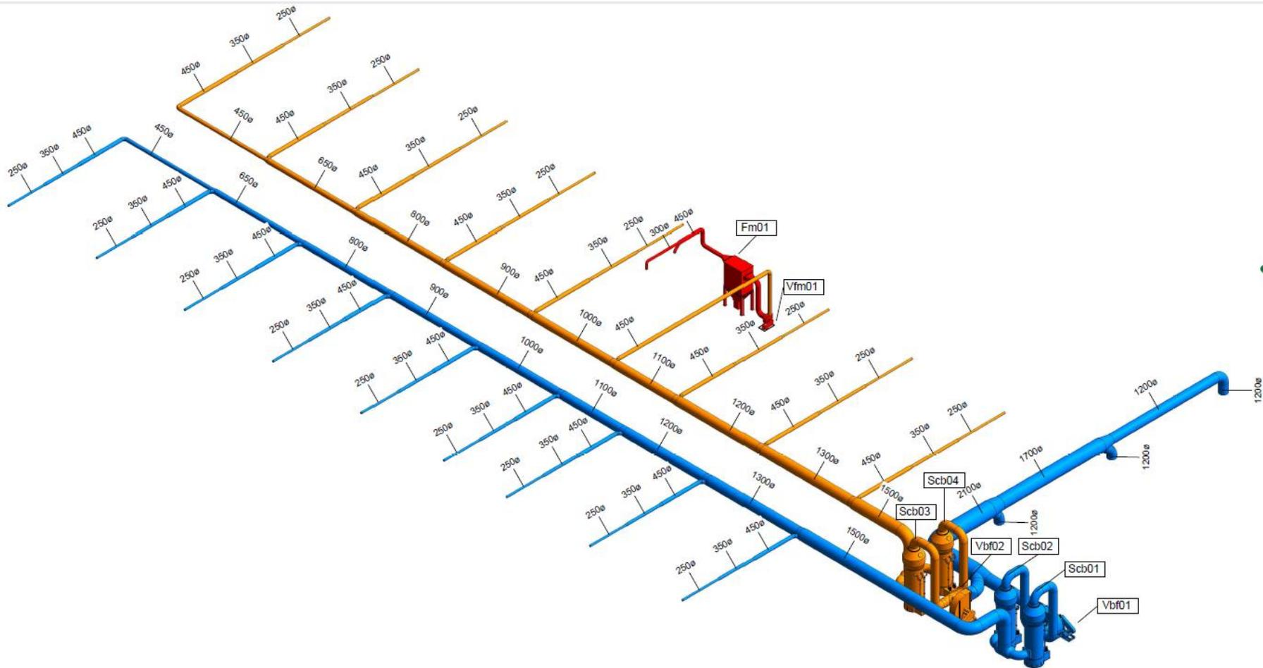
Figura 51 Vista 3D della linea di estrazione arie ambito RSU/FORSU
