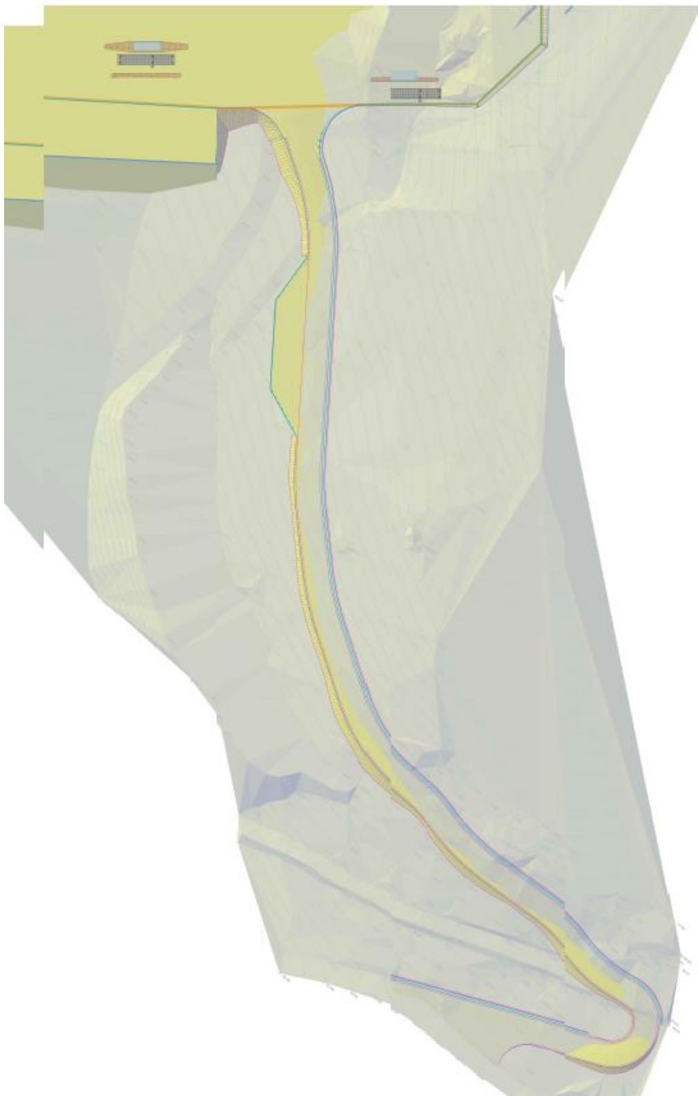
Figura 8 Dettaglio planimetrico ambito viabilità di accesso scavi (grigio) / riporti (giallo)
