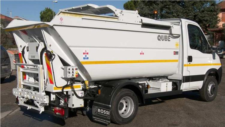
Figura 3 minicompattatore 5mc
