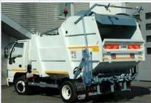
n.01 Compattatore 3 assi a caricamento posteriore di media capacità di portata di 12 mc.
